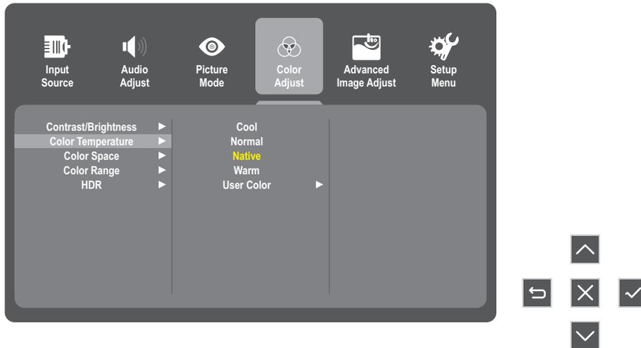
4. Mueva el **Botón de flecha** ▲ o ▼ para ajustar o seleccionar la configuración. A continuación, presione el botón
