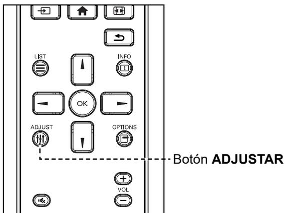
La función de ajuste automático pone a punto la fuente VGA a su configuración óptima, incluyendo la posición horizontal, la posición vertical, el reloj y la fase. Presione el botón
